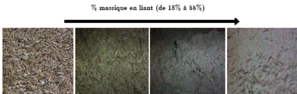
Fig. 3 (de g. à dr.) : Aspects des mortiers de chanvre frais en fonction de dosages croissants en liant.
