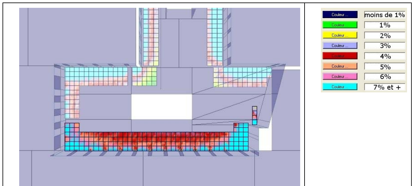
Figure 6: Résultat du FLJ pour la zone sud RDC du bâtiment.
