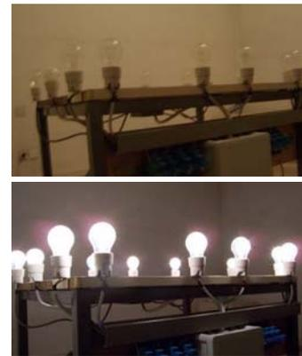
Figure 2 : Dispositif de simulation d'occupation par dégagement de chaleur
