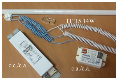
Figure 5 : Tube T5 et ses ballasts
