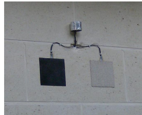
Positionnement des capteurs sur la paroi in situ
