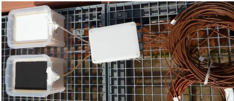
Figure 2 : Capteur de température extérieure équivalente
