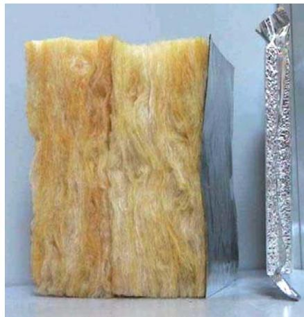
Figure 5 : Panneaux isolants sous vide
