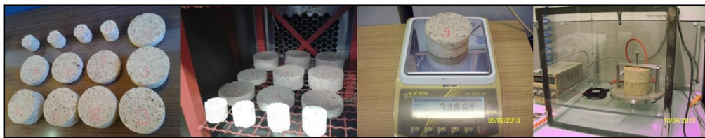
Figure 2. Types d'échantillons de béton de bois, pesée et mesure de conductivité thermique
