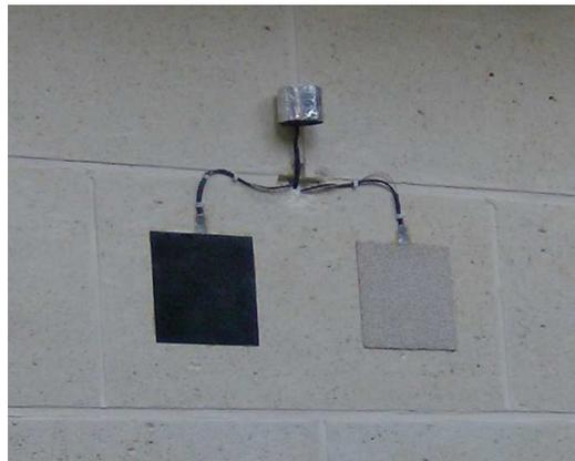
Figure 2 : Positionnement des capteurs sur la paroi in situ
