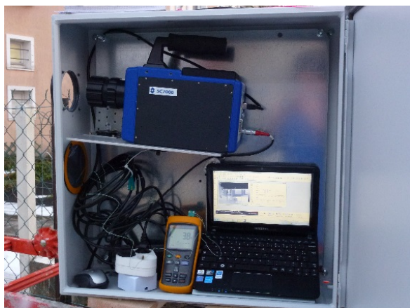
Intérieur du caisson étanche avec caméra IR
