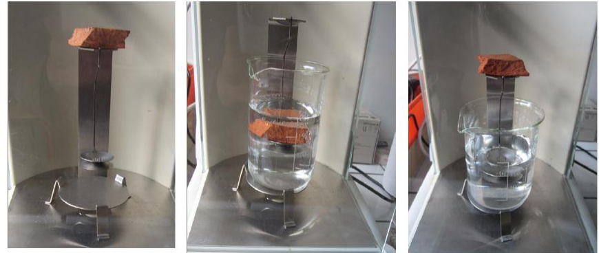
Mesure de porosité avec une balance hydrostatique
