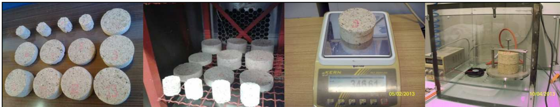
Types d'échantillons de béton de bois, pesée et mesure de conductivité thermique
