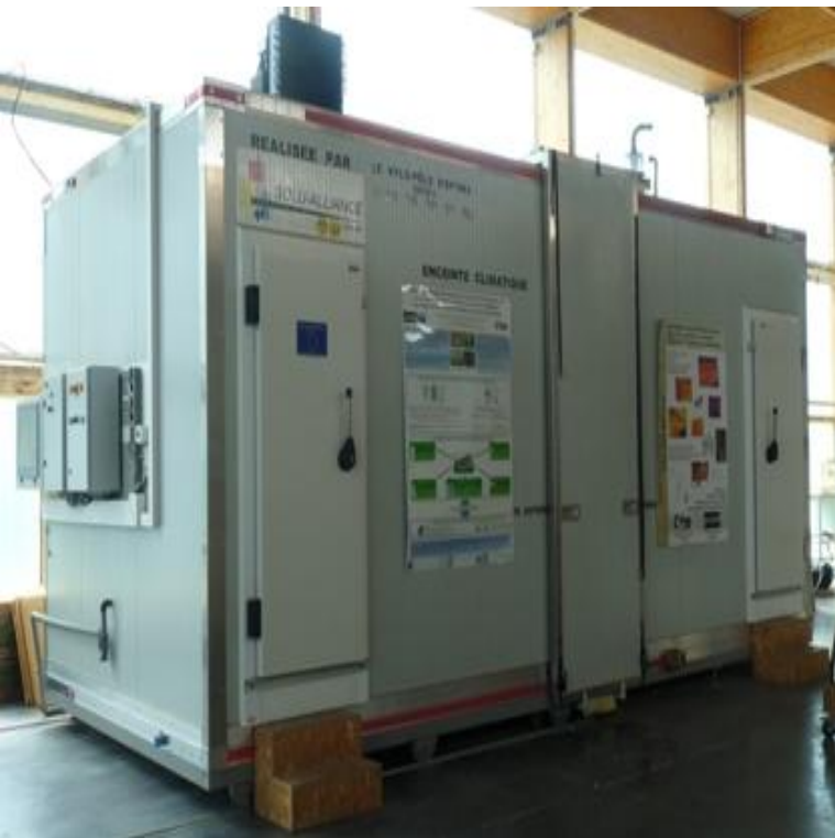
Banc expérimental : double enceinte climatique au Lermab
