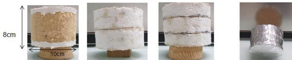
Figure 3 : Fibre de bois : différentes configurations (gauche), avec scotch aluminium (droite)
