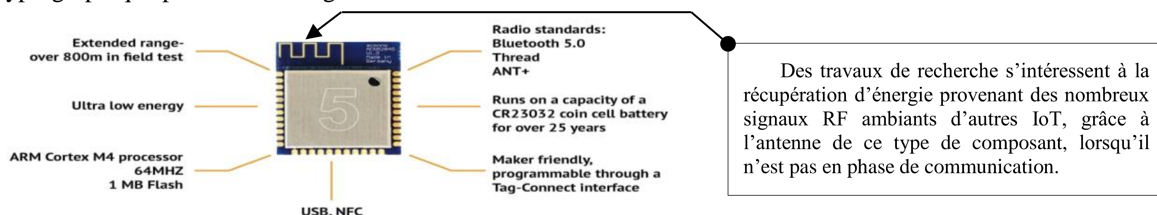
Figure 6: Puce nRF52 et son antenne de communication, voire de récupération d'énergie ambiante.
