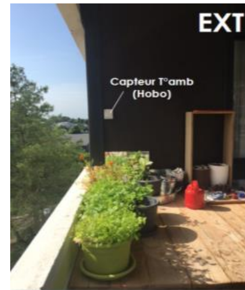
Figure 4: Emplacement du capteur de température extérieur
