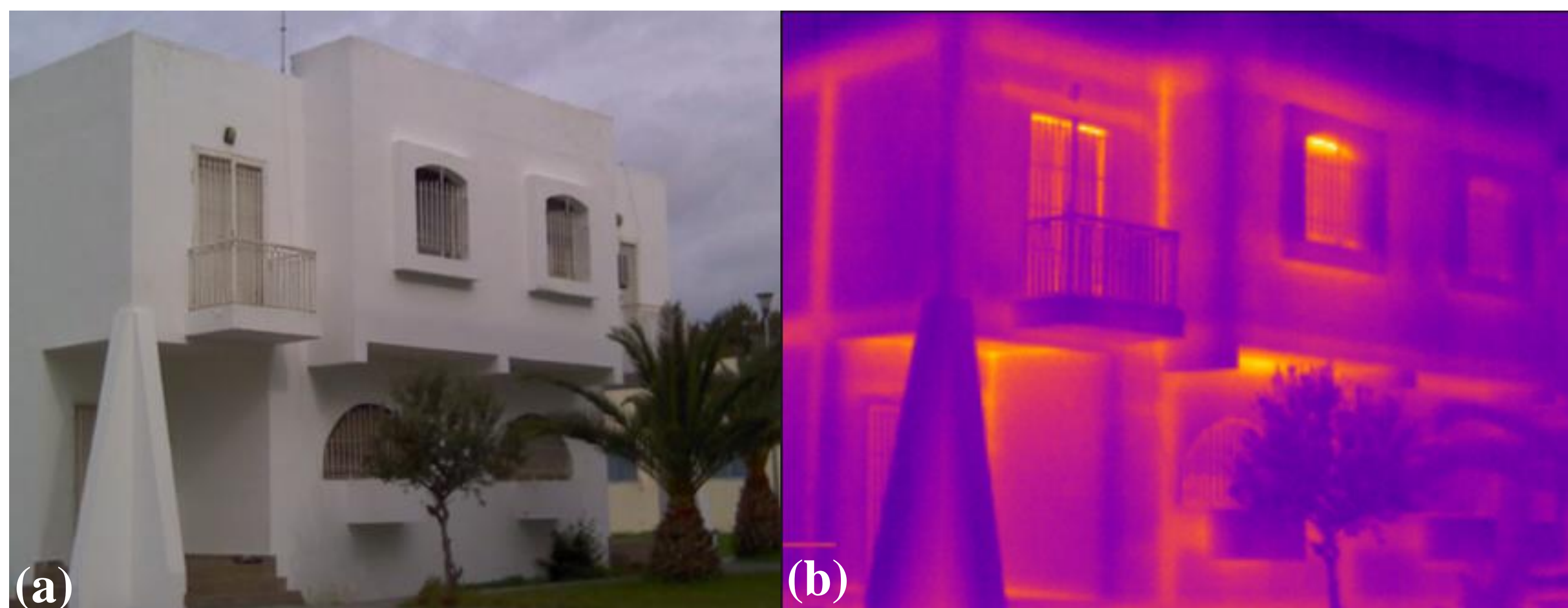
Figure 2 : (a) Photos numériques du bâtiment étudié ; (b) images thermiques du bâtiment étudié.
