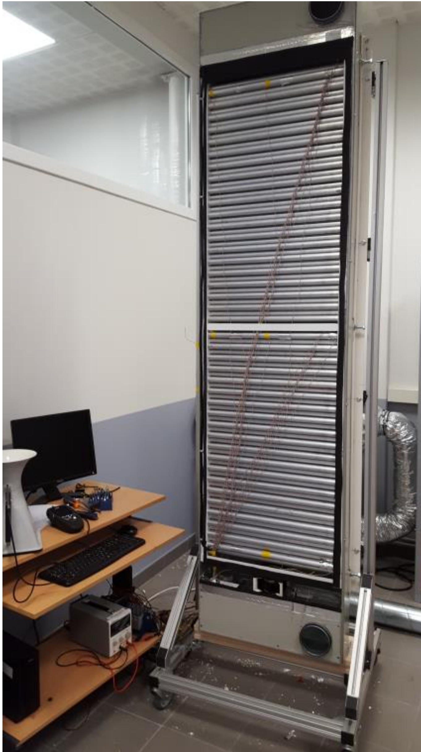
Figure 6: Photo du LHTES partiellement installé sur le banc d'essai avec les thermocouples.
