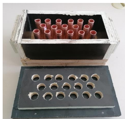
Figure 2 : Moule en bois utilisé pour les briques perforées
