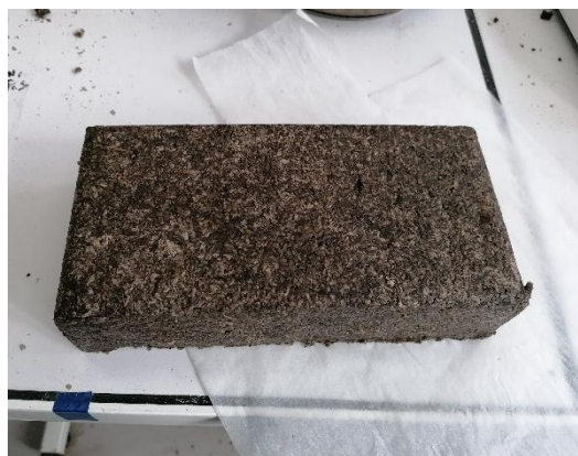
Figure 3 : Mélange chauffé dans l'autoclave
