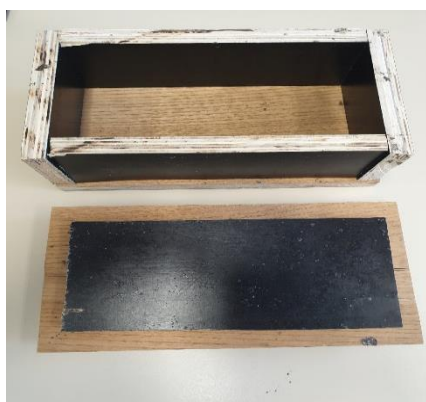
Figure 1 : Moule en bois utilisé pour les briques pleines
