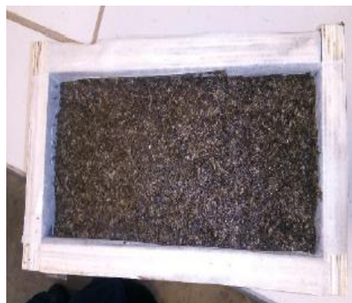
Figure 4 : Mélange coulé dans le moule
