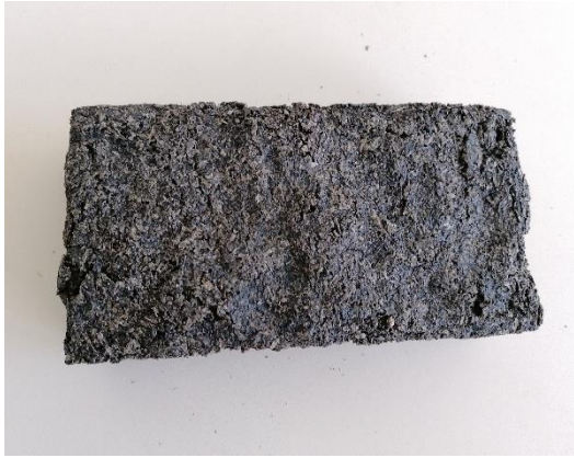
Figure 9 : Brique pleine après séchage par la tour à air chaud (étuve ventilée)
