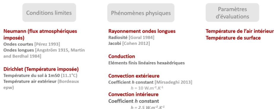
Figure 2 : Paramètres de simulation
