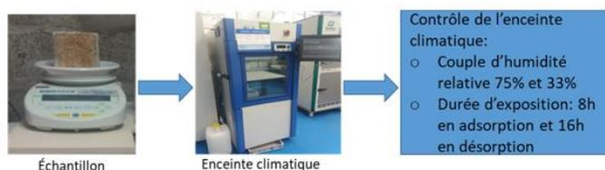
Figure 3 : Processus d'exécution du protocole d'essai du projet Nordtest pour mesurer la valeur MBV.
