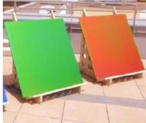
Figure 4 : Schéma d'un filtre optique multicouche (miroir de Bragg) Figure 5 : Modules PV montrant le niveau de saturation obtenu avec des filtres optiques multicouches (Bläsi 2017)
