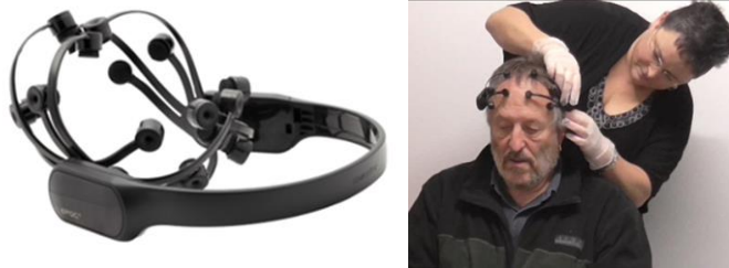
Figure 7 : Un EEG avec 12 électrodes (à gauche) et une installation d'un EEG sur la tête d'un technicien à l'Université de Massey, Nouvelle Zélande (à droite).
