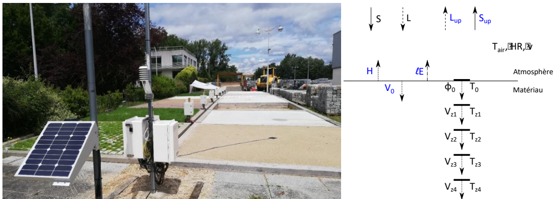
Figure 1 : Photographie du site expérimental et de son instrumentation (à gauche) Bilan thermique et grandeurs mesurées (en noir) et calculées (en bleu) (à droite).
