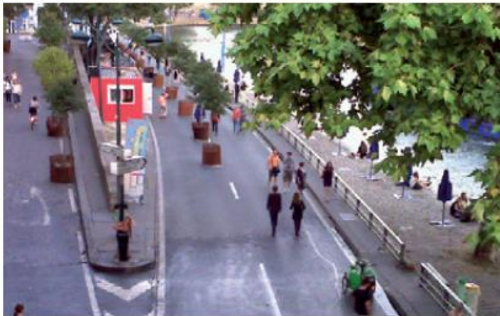
Figure 12 – Port des Célestins le 31 juillet 2011 à 21h30 : effet de refroidissement après aspersion de la chaussée. La température de la chaussée chute d'une dizaine de degrés.
